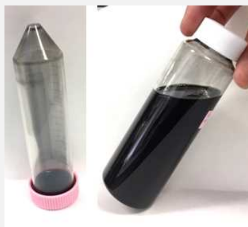
図 1. 有機溶媒テトラヒドロフランに収率 100%で分散した単層カーボンナノチューブの分散液（右）。遠心分離（13,000×g）を行った後、遠心チューブの底に不溶物が見られない（左）。
